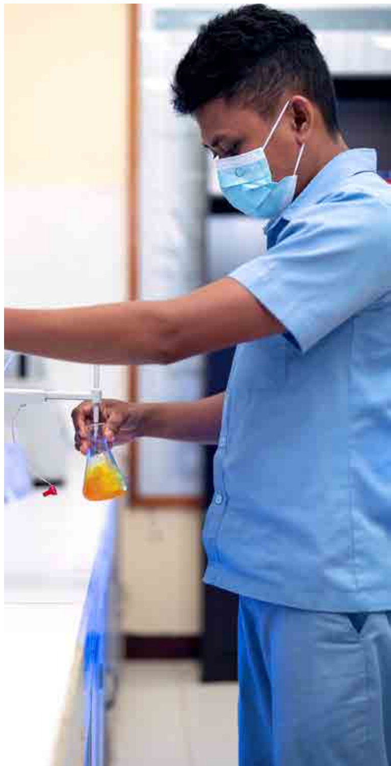
Staf laboratorium kami melakukan pengujian terhadap kualitas CPO yang dihasilkan pabrik kelapa sawit kami.
